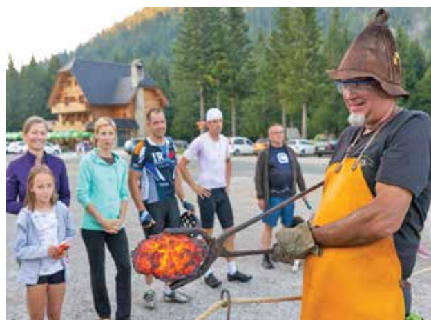
Volk - končni izdelek železnodobnega taljenja. (foto: Simon B.)
